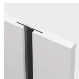
łączenie z szybą „na kant” skrzydło bezprzylgowe
