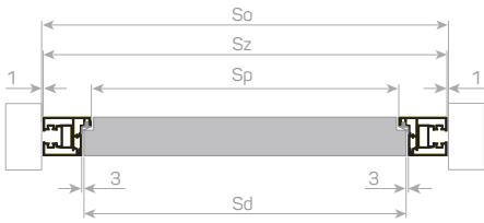
DRZWI CU - SKRZYDŁO DREWNIANE DOORS CU - WOODEN DOOR LEAF
