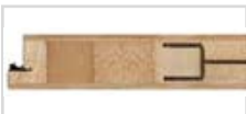
SKRZYDŁO HERSE SET AKUSTIC 39 dB gr. 46 mm, wzmocnione ceownikiem i blachą stalową
